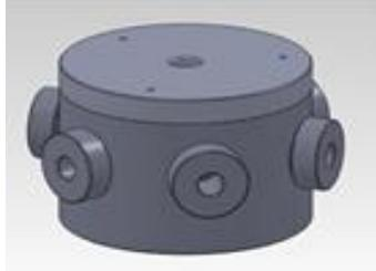
Naso artificiale (array di sensori a foto-ionizzazione) per la rilevazione della tipologia e della concentrazione di inquinanti in mare installato su un veicolo autonomo subacqueo
